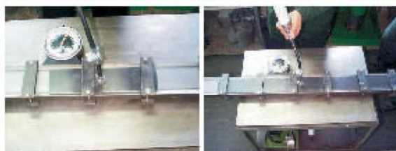
Изготовление плоских направляющих впрыскиванием moglice P500
