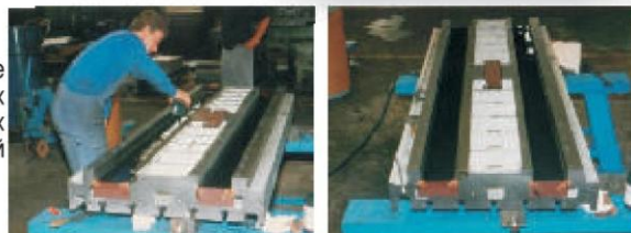
Формирование плоских направляющих заливкой
