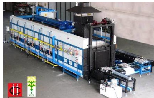
ПРОХОДНЫЕ ТОННЕЛЬНЫЕ ПЕЧИ С РЕКУПЕРАТИВНЫМИ ГОРЕЛКАМИ ДЛЯ ПРЕДВАРИТЕЛЬНОГО НАГРЕВА ФОРМ
