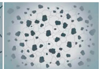
высокопрочный чугун с шаровидным графитом
