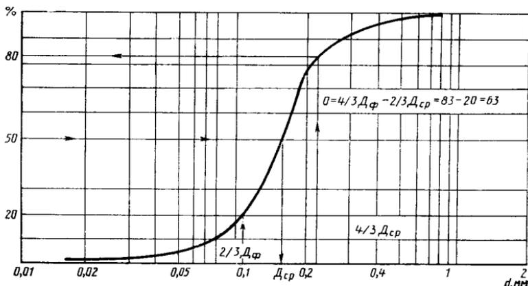
ческом масштабе размер сторон ячеек сетки в свету, а по оси ординат в линейном масштабе количество частиц меньше данного размера в процентах (чертеж).
